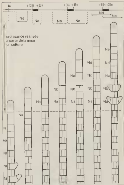
Fig. 1. — Représentation schématique de la croissance d'apex témoins. Le rythme de division de la cellule apicale est régulier. Les ramifications apparaissent à une distance constante de l'apex ( N_n = nœuds numérotés successivement au fur et à mesure de leur apparition). Temps exprimé en heures à partir de la mise en culture ( t_0 ). Période obscure indiquée en noir.
